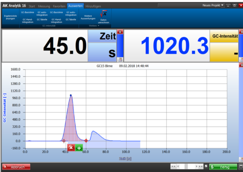
Abbildung 7: Gaschromatogramm des Reaktionsgemischs mit H_2 und CH_4
